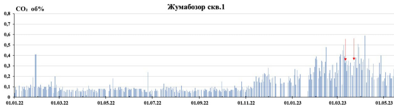
1-расм. Жумабозор-№1 бурғи қудуғида углерод тўрт оксидининг ўзгариш графиги.
