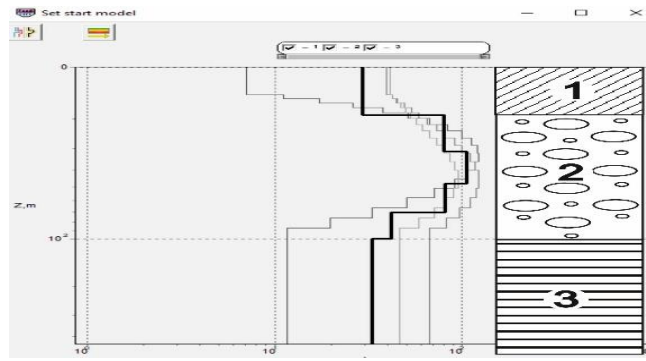
5-rasm. EMI signallarning gruntlardagi qarshilik grafigining tog' jinslari litologik chegaralari bilan mosligi. 1 – supes-suglinoq, 2 – galechnik, 3 – gill va gilli tog' jinslari.
